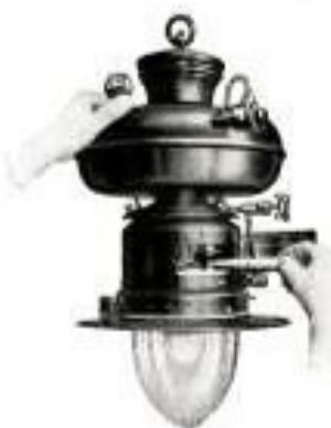
Abb. 6. Die Düse wird mit der Düsennadel gereinigt.
