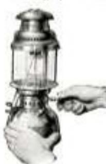
Abb. 10. Nach erfolgter Düseneinigung muss die Kerbe der Fibreschelle wieder nach unten stehen.
