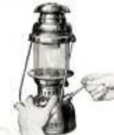
Abb. 9. Nachdem der Spiritus in der Arbeitschale ausgebrannt ist und nur noch die Zündflamme sich zeigt, wird die Entzündungsschraube geschlossen und Luft in das Bassin gepumpt.
