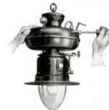
Abb. 5. Es wird Druck in den Behälter gepumpt, bis der Zeiger des Manometers auf dem roten Strich des Zifferblattes steht.
