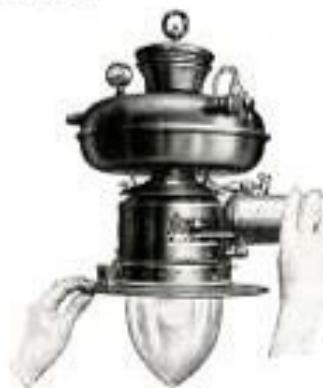
Abb. 7. Die Anheizschale wird mit Spiritus gefüllt.
